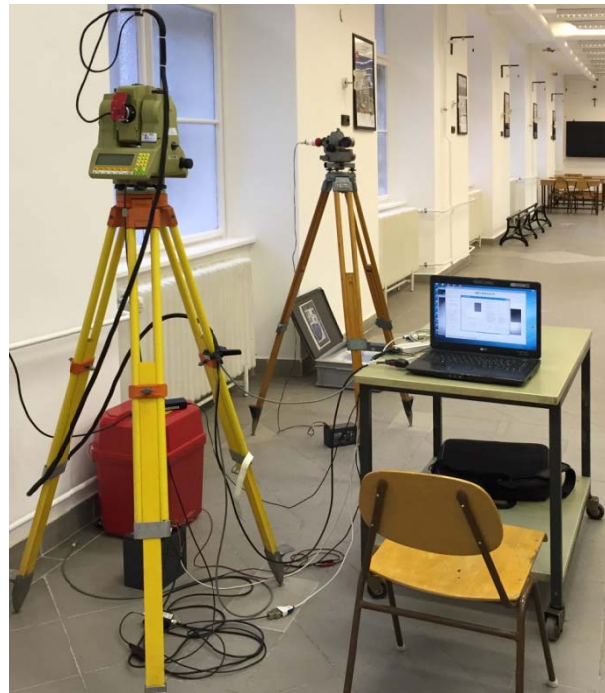
4. ábra. Az ATK-2 kollimátor és a kollimátoros kalibrálás laboratóriumi testje
