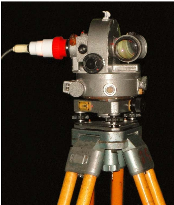
4. ábra. Az ATK-2 kollimátor és a kollimátoros kalibrálás laboratóriumi testje
