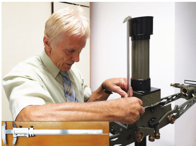
19. ábra A felfüggesztő szál hosszának mérése precíziós hosszú szárú tolómérővel
