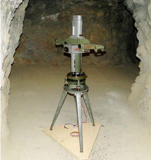
4. ábra. A felújított Auterbal-inga a Mátyás-barlagban Figure 4 The renewed Auterbal torsion balance in the Mátyás cave
