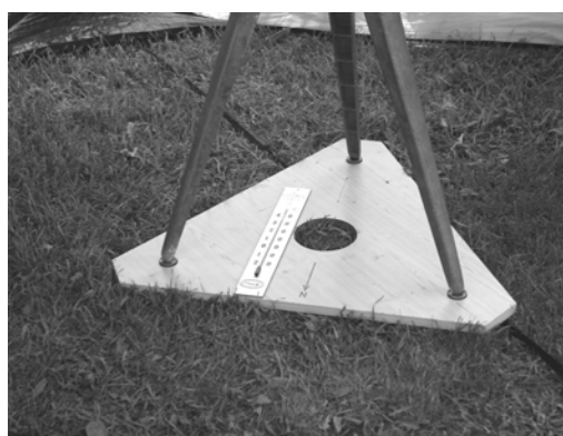
12. ábra. Teherelosztó háromszög az ingalábak alatt
