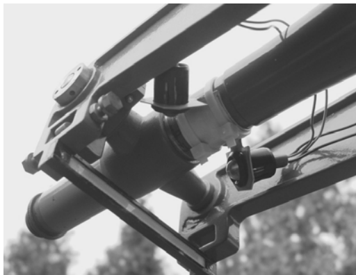
9. ábra. A skála megvilágítása fénykibocsátó diódákkal
