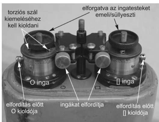
2. ábra. A torziós szálak beszállító csavarjai
