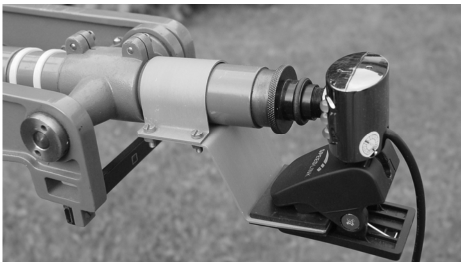
16. ábra. CCD-érzékelős kamera a leolvasókaron.
