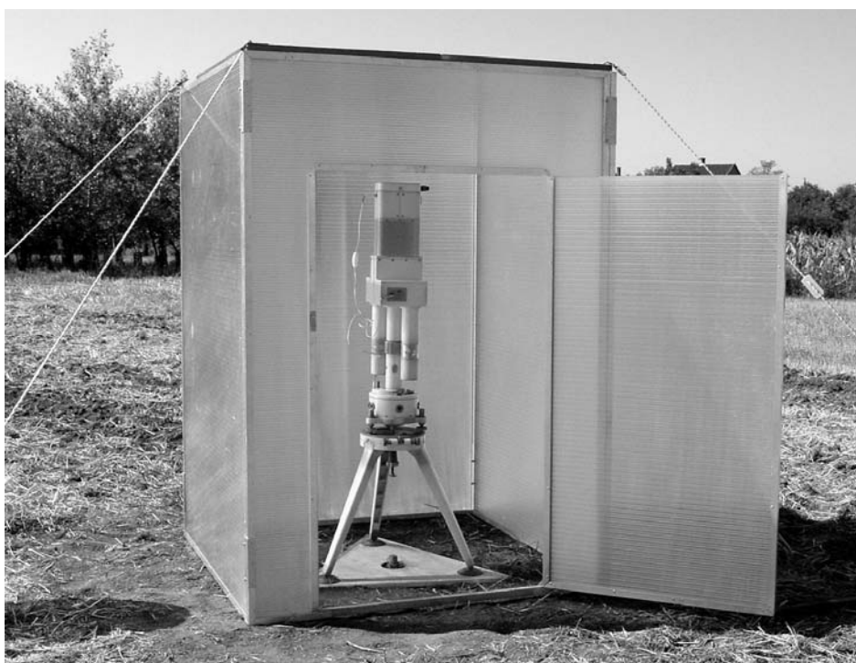
2. ábra. Eötvös-inga mérésre kész állapotban Makád határában 2007-ben.
