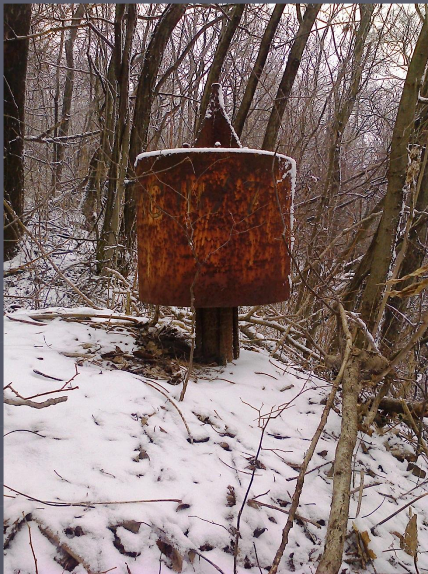
MÉLYÉPTERV által 1974-ben létesített mozgásvizsgálati mérőpont
