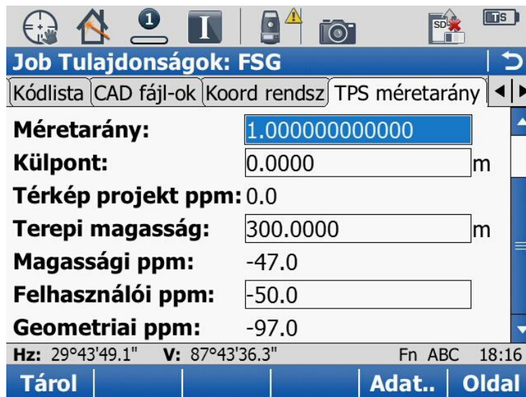
1.3. ábra Leica TS15i: tengerszinti (alapfelületi) redukció és vetületi redukció összevont beállítása szorzóállandóként
