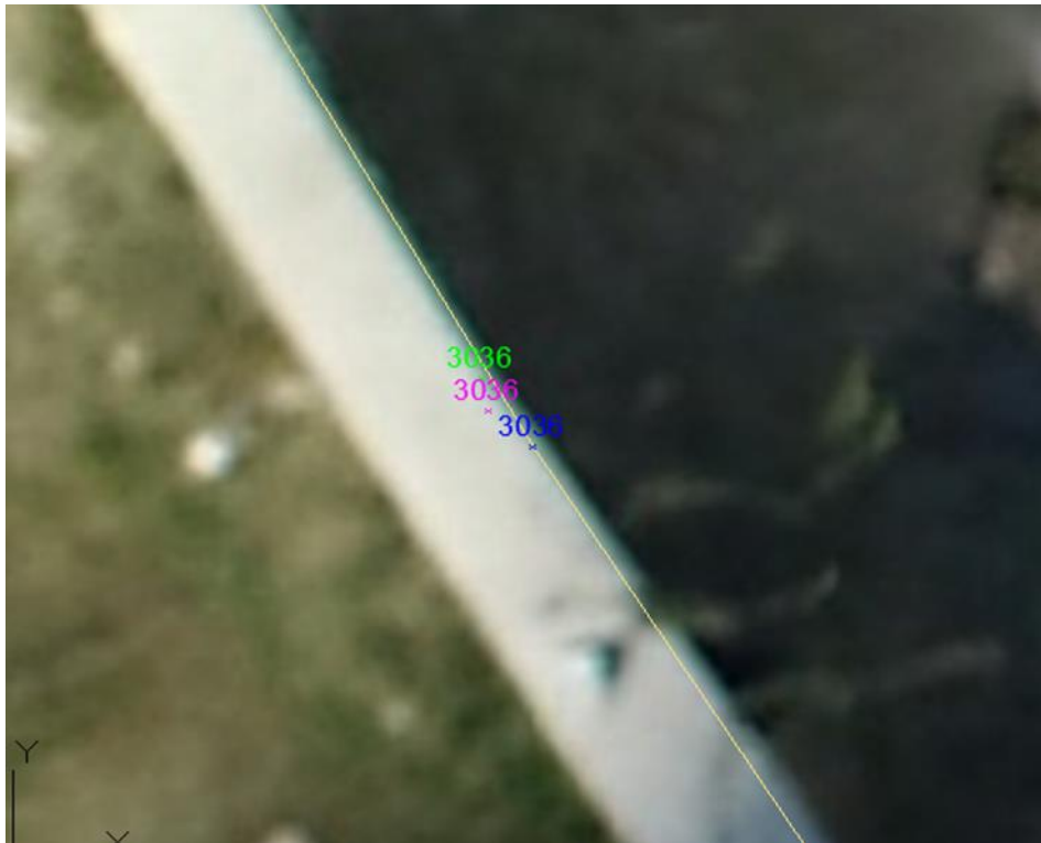
Elhatárolásbeli eltérések a különböző felmérési technikák között (kék: földi, lila: mobil, zöld: statikus felmérés)
