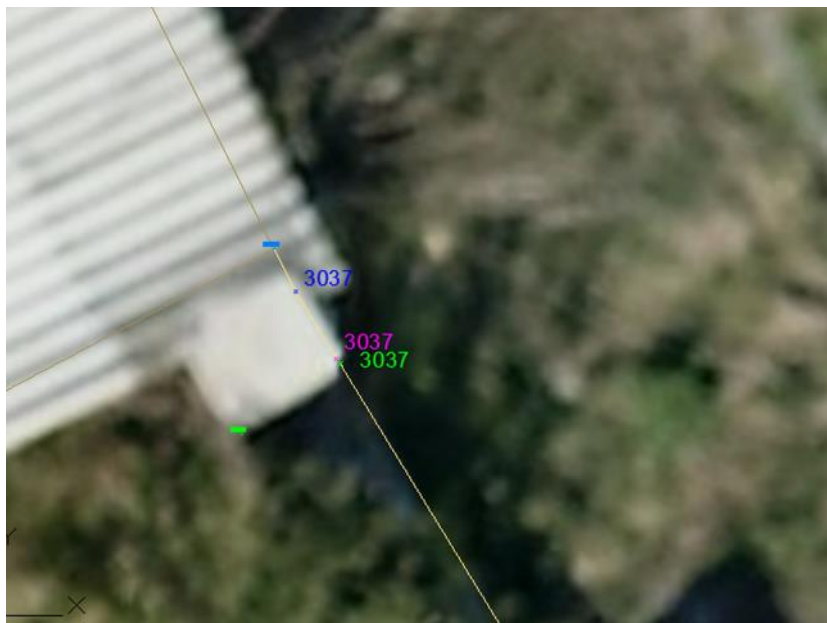
Elhatárolásbeli eltérések a különböző felmérési technikák között (kék: földi, lila: mobil, zöld: statikus felmérés)
